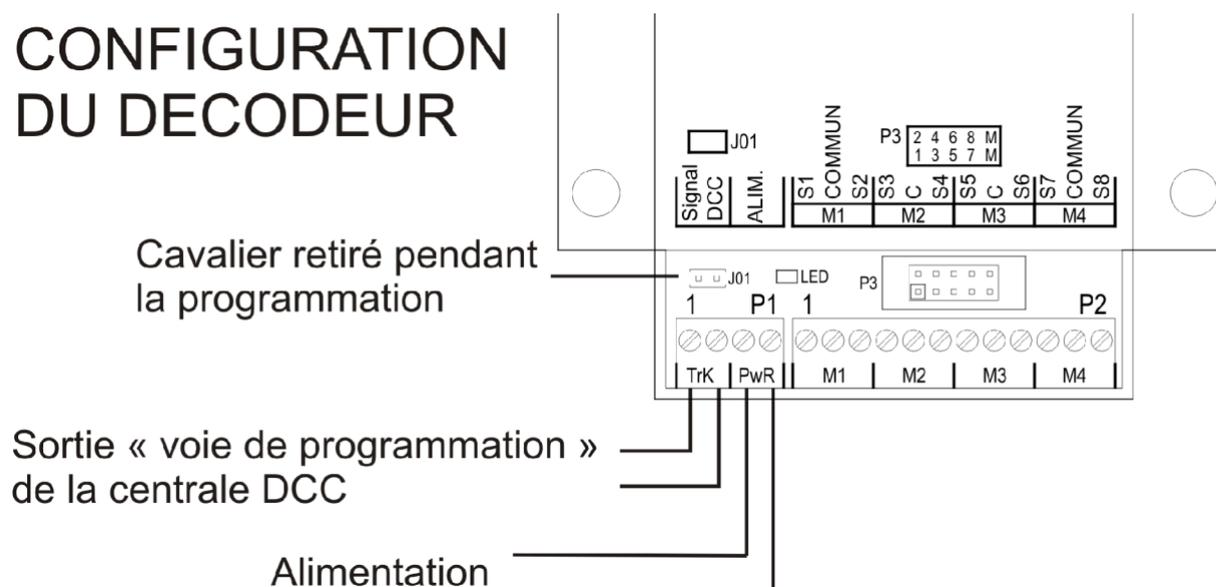
Pour réaliser la **configuration du décodeur**, celui-ci devra être relié à la sortie "**voie de programmation**" de la centrale DCC (bornes 1 et 2 du connecteur P1) ainsi qu'à une source d'alimentation (bornes 3 et 4 du connecteur P1).
