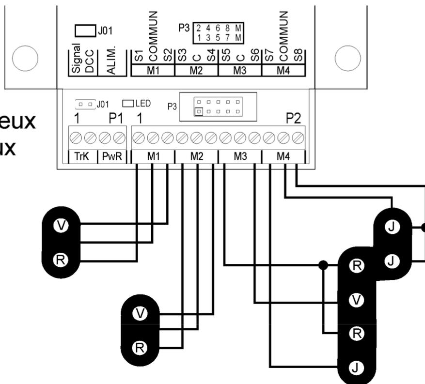
**MODE 5 :** Les sorties S1 et S2 sont utilisées pour le signal à 2 feux, les sorties S3 à S8 pour le signal à 6 feux.
