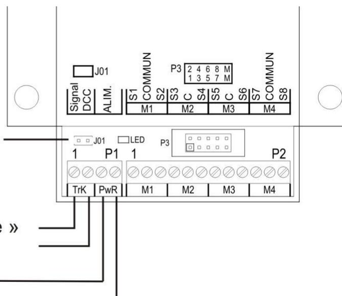
Lors de la mise en service du décodeur, celui-ci devra être relié à la sortie "voie principale" de la centrale DCC pour recevoir les instructions (bornes 1 et 2 du connecteur P1), ainsi qu'à une alimentation délivrant une tension alternative ou continue de 12 à 16V (bornes 3 et 4 du connecteur P1). On vérifiera que le cavalier de protection J01 a bien été remis en place. Enfin les signaux seront reliés aux bornes du connecteur P2.
