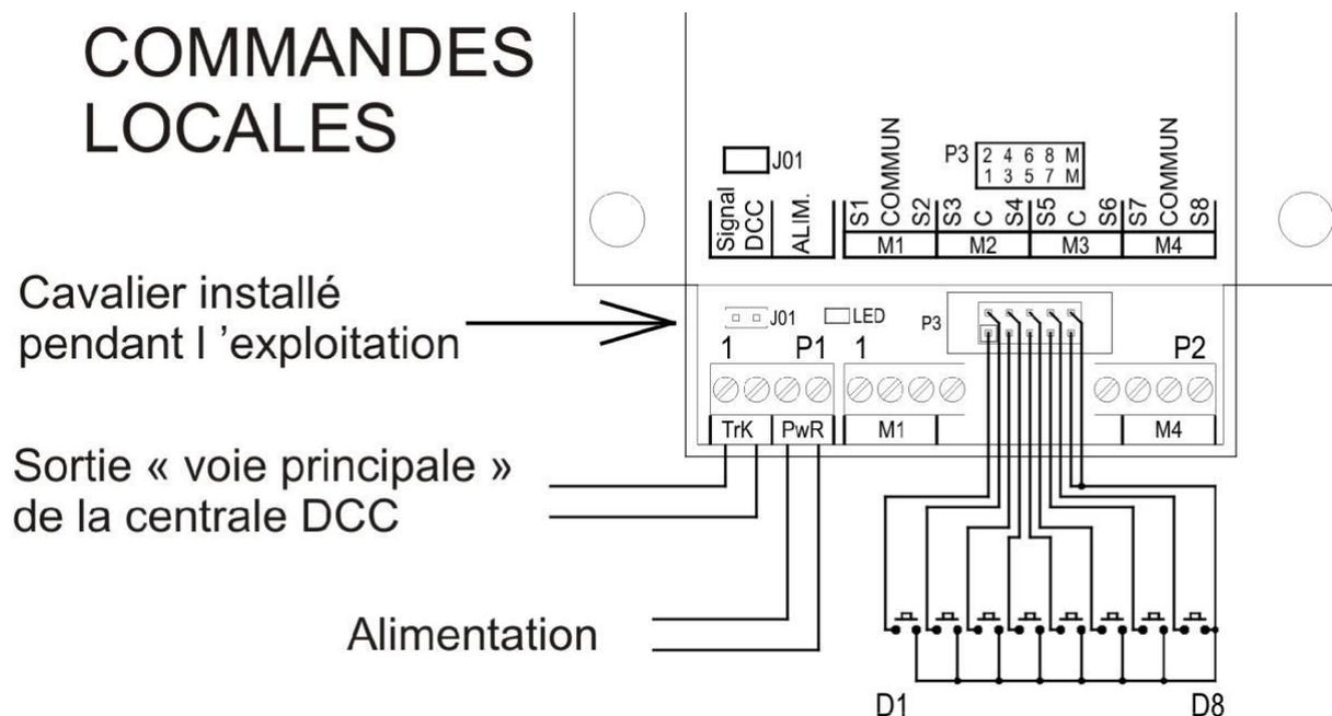
Le décodeur CDF 80108007S peut être relié à des boutons-poussoirs, des ILS ou des contacts de relais pour commander localement les signaux. Ces commandes locales agissent uniquement lors de la fermeture du contact. Si le même signal est manœuvré successivement localement et depuis la centrale DCC, c'est la dernière commande reçue qui est prise en compte.
