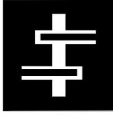
Le pictogramme « **Baissez panto** » commande au conducteur d'abaisser le ou les pantographes. La zone à franchir pantographes abaissés est repérée par une signalisation complémentaire au sol décrite à l'article 703 du titre I.
