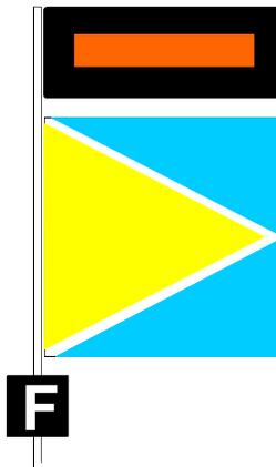
Cette bande lumineuse jaune horizontale, associée à un repère F, commande au conducteur d'être en mesure de s'arrêter à quai sur une distance réduite.
