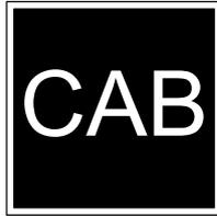
Un tableau "CAB" (ou provisoirement "TGV"), à lettres blanches sur fond noir est implanté à hauteur du dernier panneau de signalisation au sol (ou immédiatement en aval de ce panneau). Ce tableau est précédé par un ou plusieurs tableaux "CAB" (ou provisoirement "TGV"), à lettres noires sur fond blanc.
