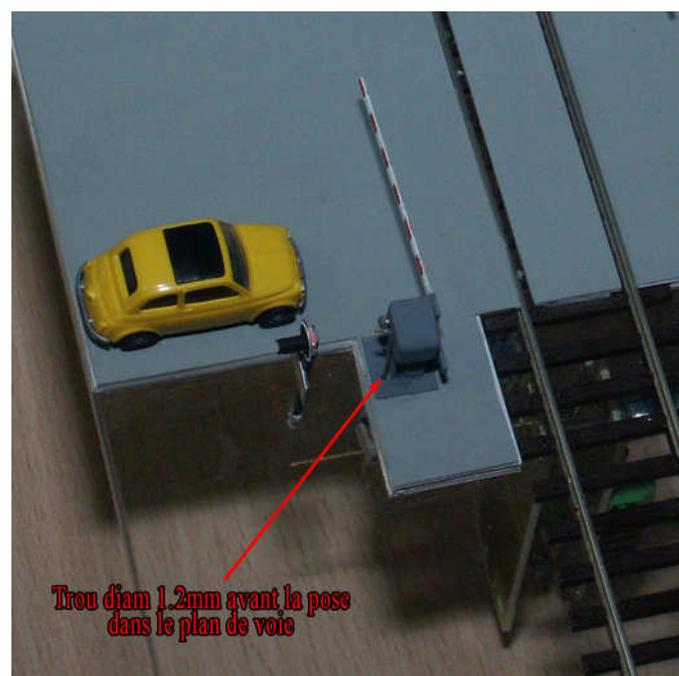
Trou diam 1.2mm avant la pose dans le plan de voie
